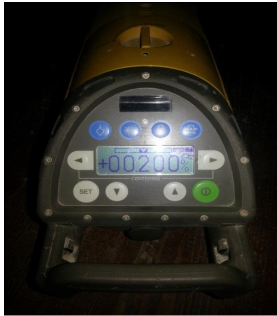
Resim 4.4. Lazer sistemi paneli üzerine girilen eğim değeri
