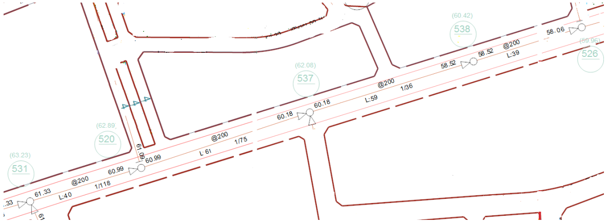
Resim 4.6. 531, 520, 537, 538 ve 526 numaralı muayene bacalarının proje görüntüsü
