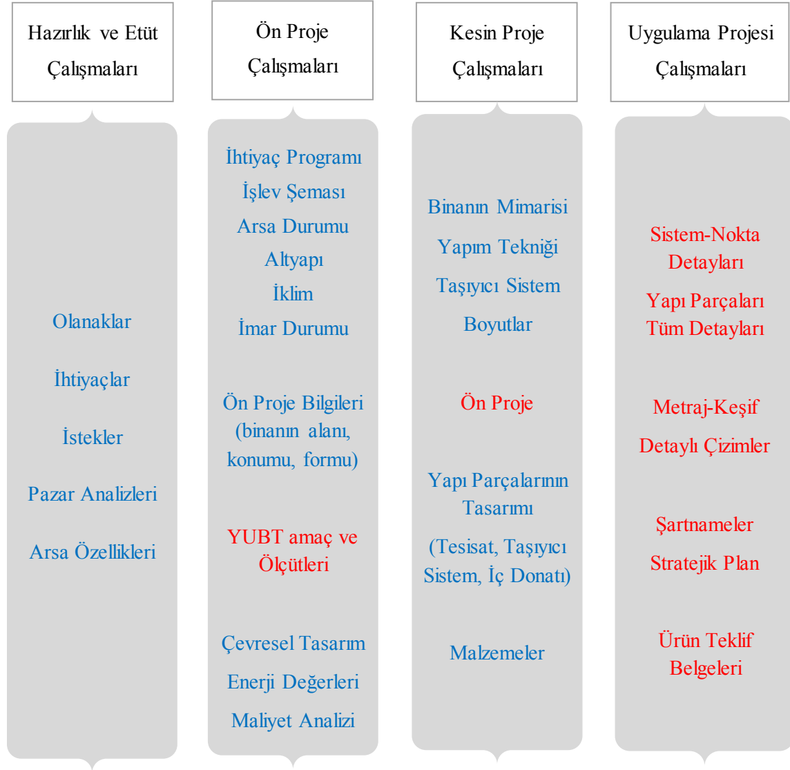
Şekil 2.1. Yapıbozumuna uygun bina tasarımı sürecinin özeti
