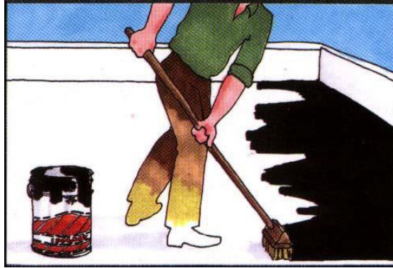
Şekil 2.8. Yalıtım olarak kullanılan karışımın katları arasında taşıyıcı serilmesi [22]
