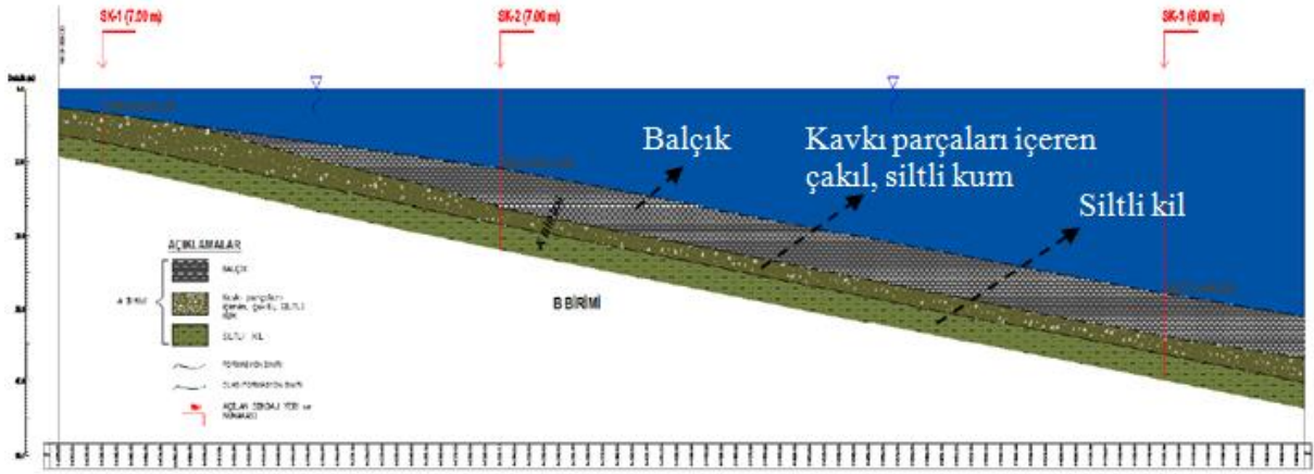
Şekil 4.2. Yalova (Merkez) Derin Deniz Deşarjı Projesi deşarj hattı jeolojik kesiti (İller Bankası, 2012:46)
