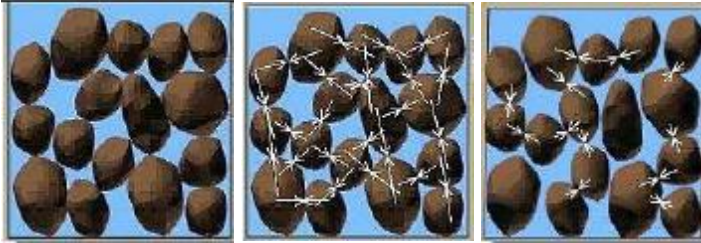
Şekil 3.12. Boşluk suyu basıncındaki ani artış sonucu zemin daneleri arasındaki temas kuvvetlerinin değişimi [65]
