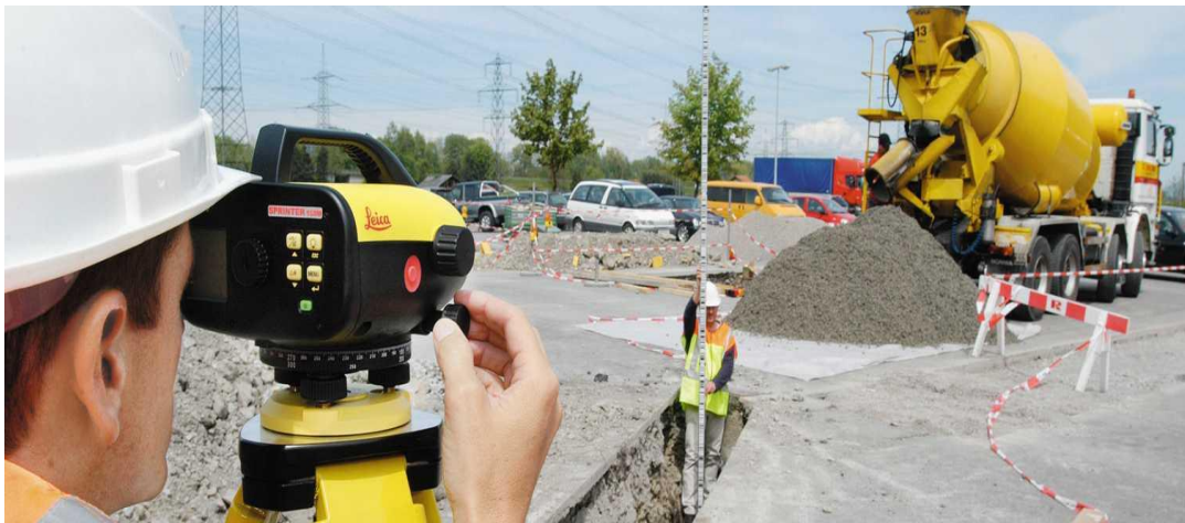
Resim 3.4. Sayısal nivo ile nivelman yapılması [10]
