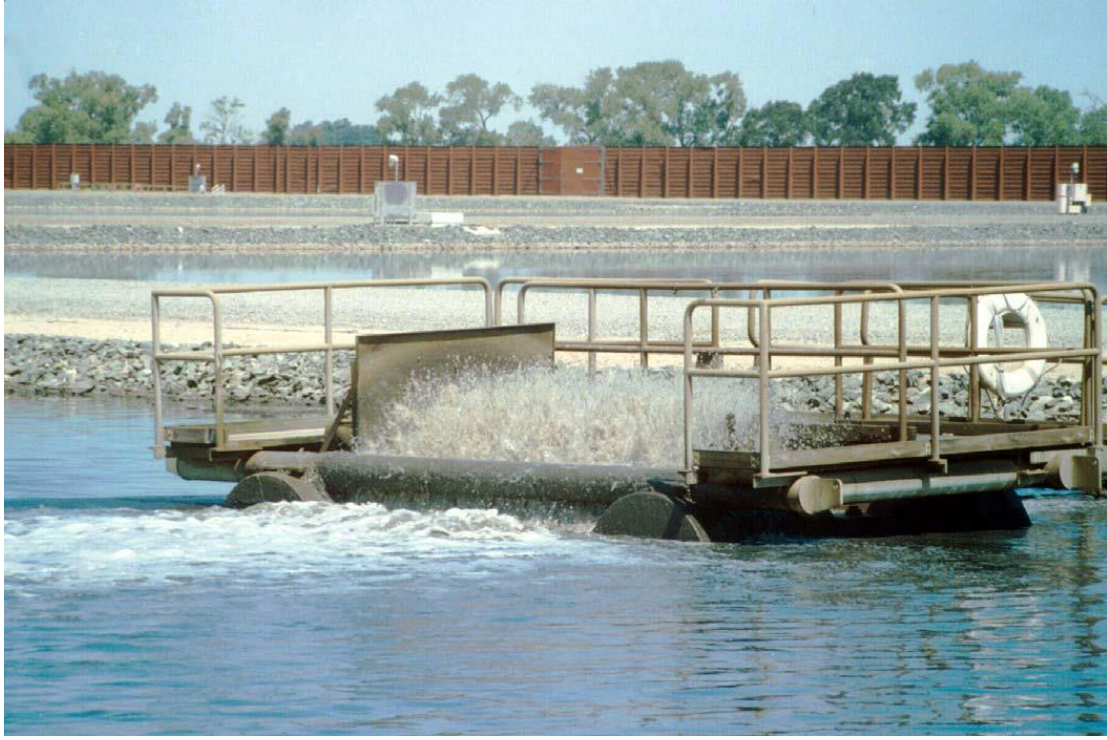
Resim 4.30. Dubalı yatay milli havalandırıcı [26]
