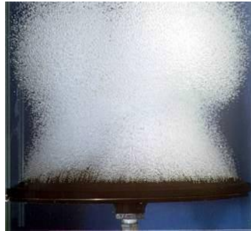
Resim 4.12. İnce gözenekli disk difüzörlerin çalışması [34]
