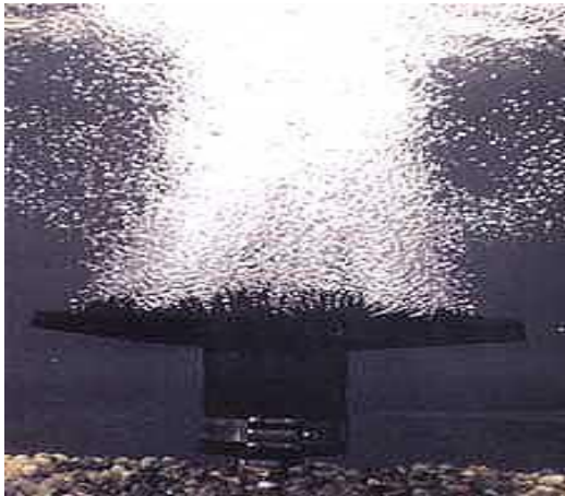
Resim 4.12. İnce gözenekli disk difüzörlerin çalışması [34]
