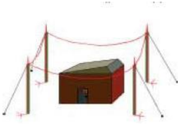
Şekil 3.3. Gerili tellerle korunma [2]
