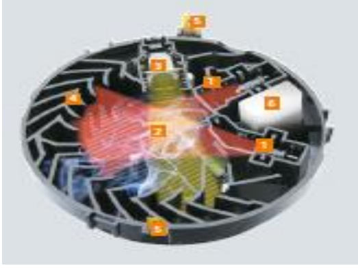
Şekil 4.3. CO ( Karbonmonoksit) sensörlü kombine dedektörün iç yapısı [10]
