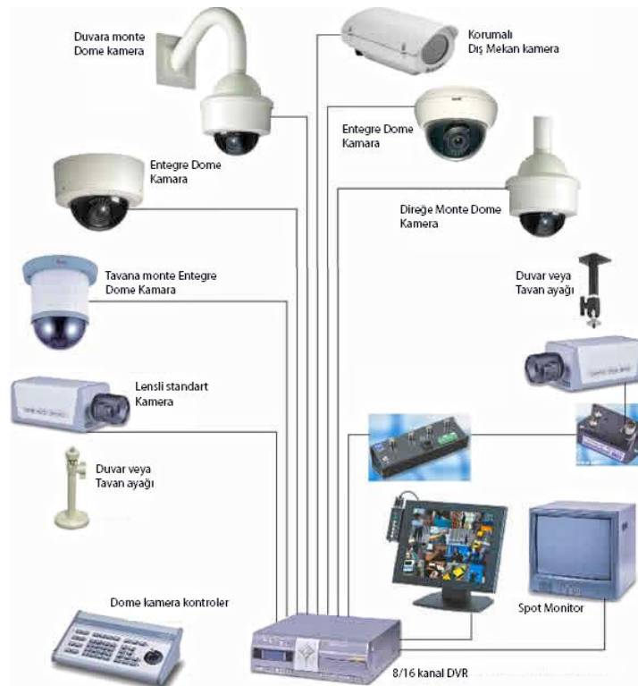
Resim 3.5. Analog kamera sistemi prensip şeması
