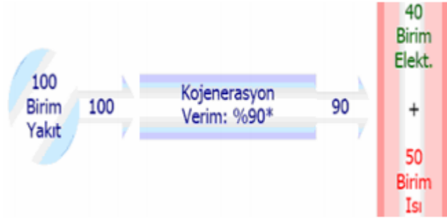
Resim 2.20. Kojenerasyon sisteminde elektrik ve ısı üretim verimi
