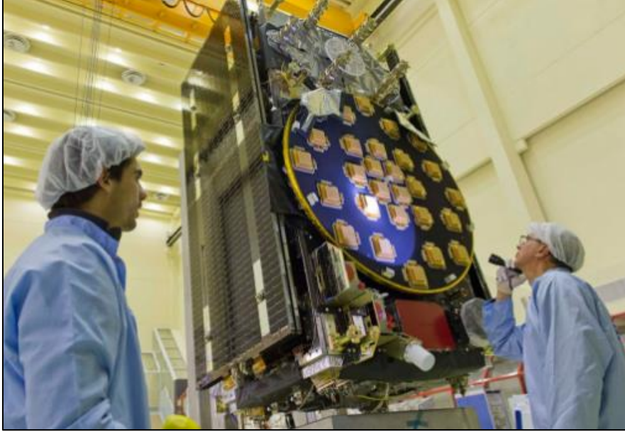
Resim 3.2. Galileo uydularından bir tanesi test edilirken [8]
