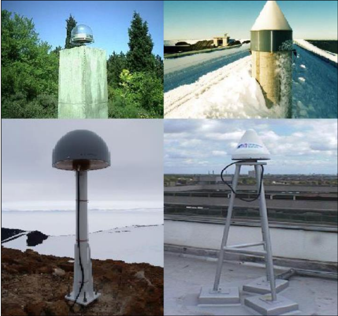
Resim 3.1. Farklı özellikte sabit GPS/GNSS istasyonları [7]
