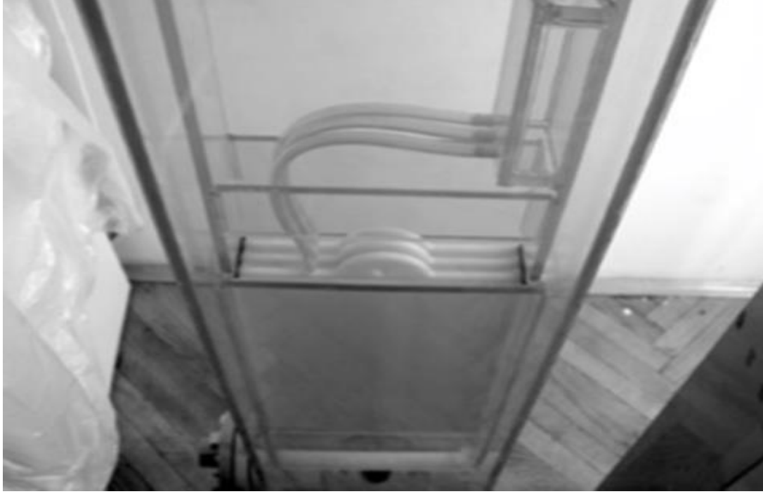
Resim 2.6. Tabaka ve çerçeve/düz levha modüller (Radjenovic ve diğerleri, 2007: 45)
