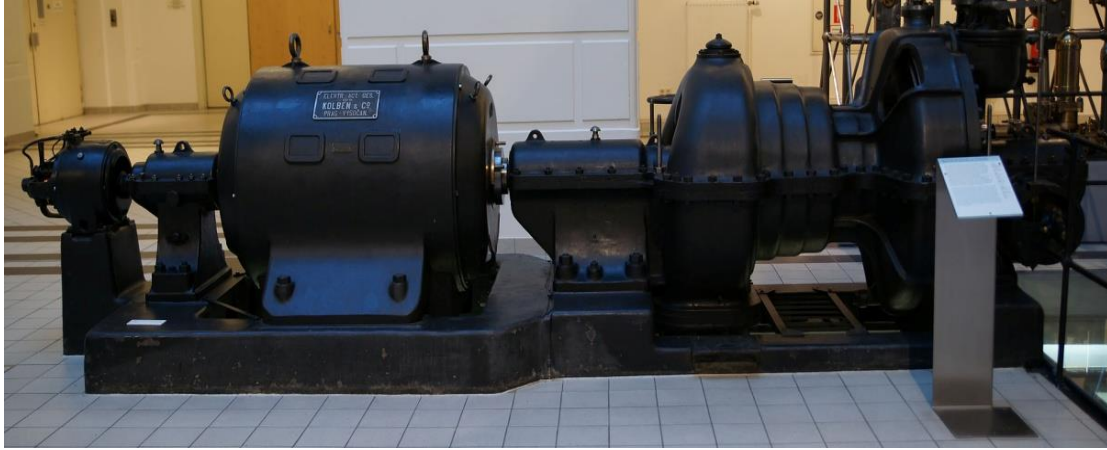
Resim 3.2. 1910 kW endüstriyel buhar türbini doğrudan elektrik jeneratörü (solda) ile bağlantılı (Vikipedi, 2016c)
