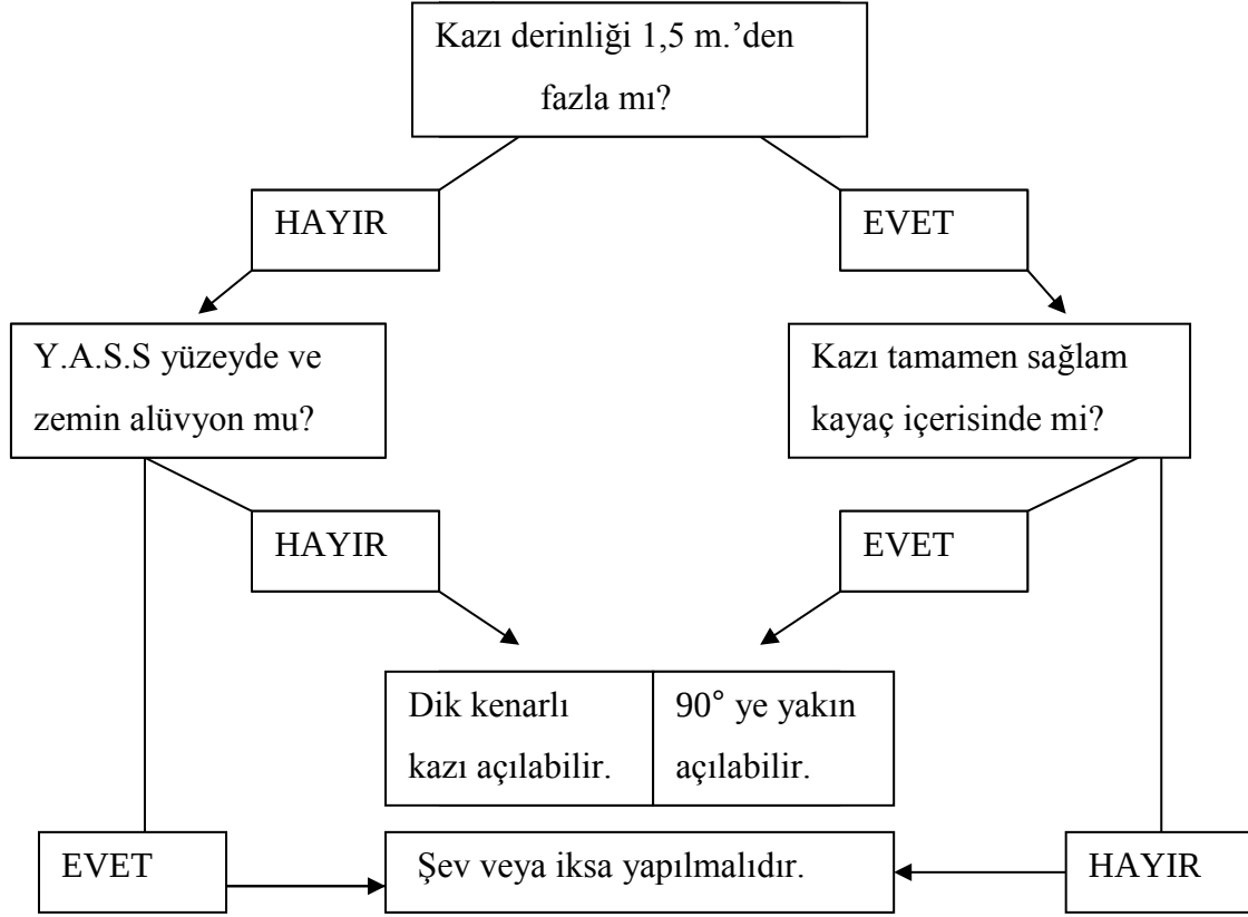
Şekil 1.1. Dik kenarlı kazıya karşı şevli kazı, iksalı kazı ayırımına ait şekil (Danacı, 2009:4)
