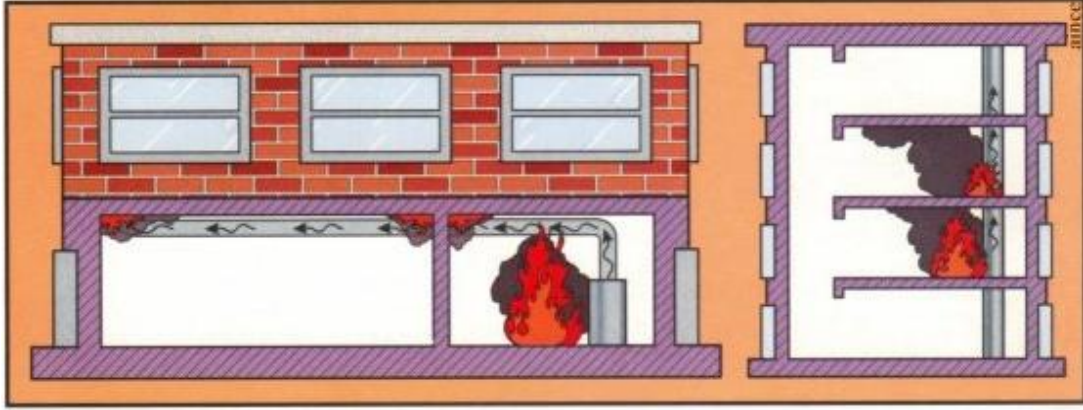
Şekil 1.3. Kondüksiyon (iletim) yoluyla ısı iletimi (İnternet 2)
