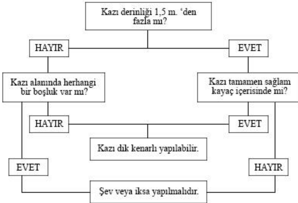
Şekil 2.3. Kazı derinliğine göre şev veya iksa uygulamasının belirlenmesi
