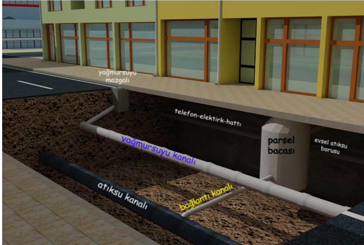
Resim 2.1. Ayrık atık su sistemi elemanları
