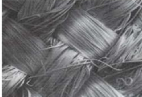
Şekil 2.1. Örgülü multifilament geotekstil (x30 büyütülmüş hali)
