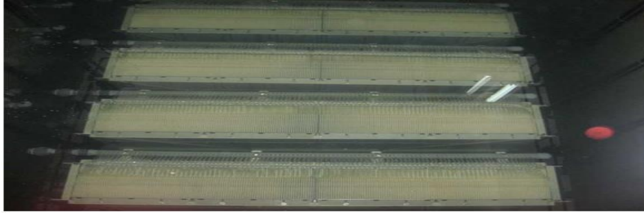
Resim 2.18. Membran biyoreaktör prosesi [7]
