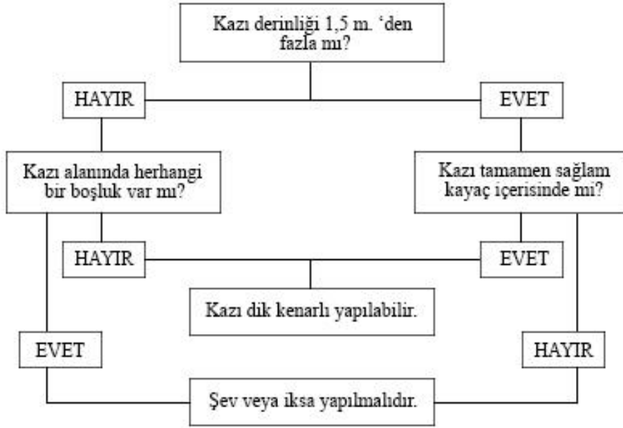
Şekil 4.17. Koruyucu iksa sistemlerinin tespiti [27]
