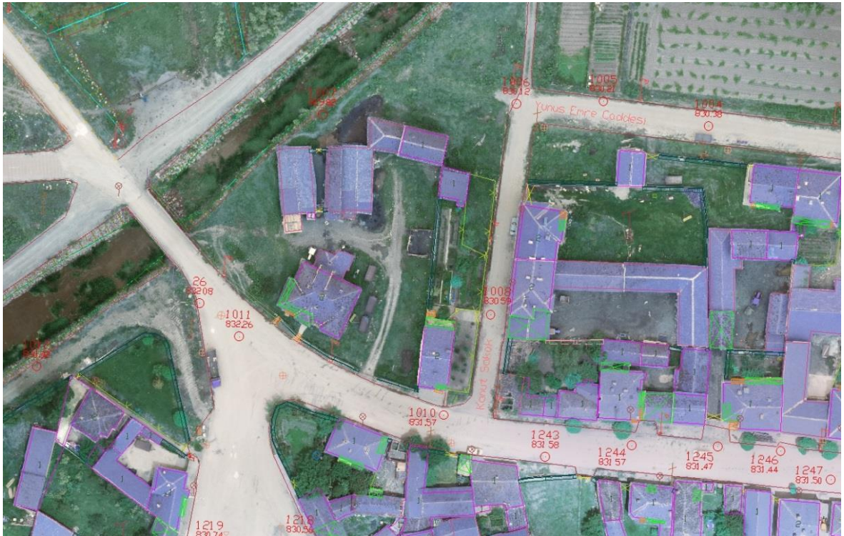
Resim 5.8. Yersel yöntemlerle üretilen halihazır harita ile ortofotonun karşılaştırılması
