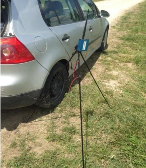
Resim 5.6. İnsansız hava aracı yer kontrol istasyonu
