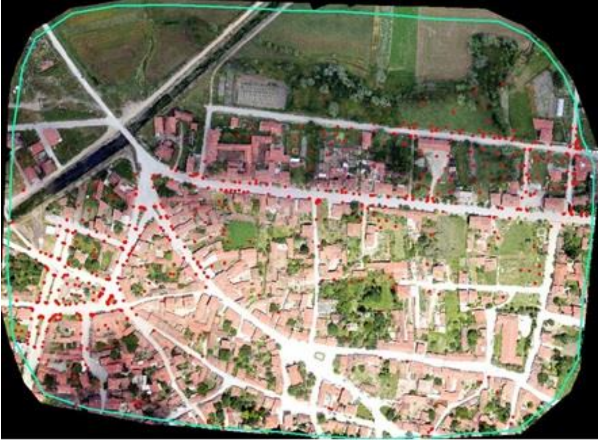
Şekil 5.8. Kot karşılaştırması yapılan noktalar
