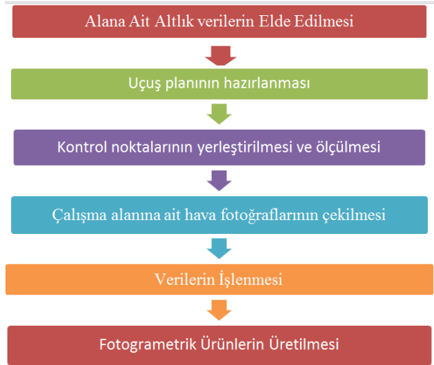
Şekil 4.7. İHA ile yapılan fotogrametrik amaçlı veri toplama ve üretimi aşamaları
