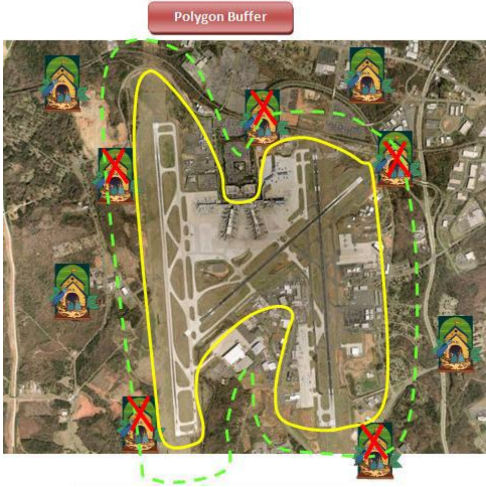
Şekil 2.32. Poligon tabanlı yakınlık analizi (Şişman, 2012)
