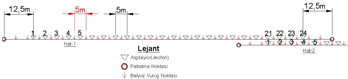
Şekil 4.2. Sismik Yansıma Arazi Çalışması Serim Geometrisi
