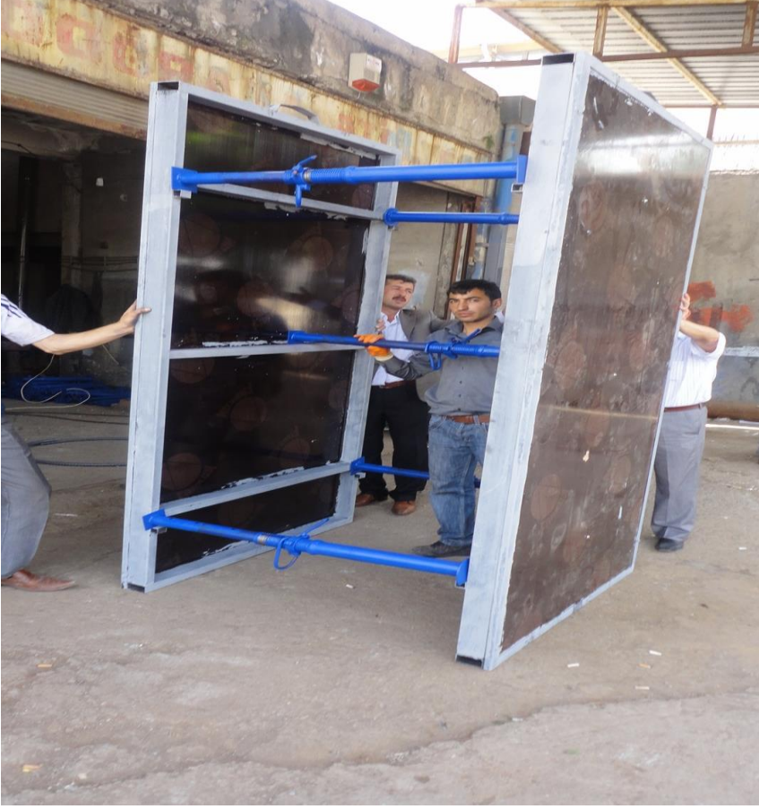
Resim 9.1. Atölyede üretilmiş örnek kutu profil çerçeveli sac iksa
