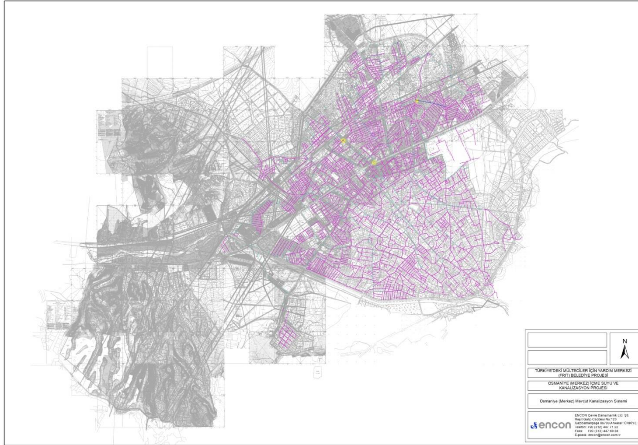
Şekil II.15. Osmaniye (Merkez) Mevcut Kanalizasyon Sistemi
