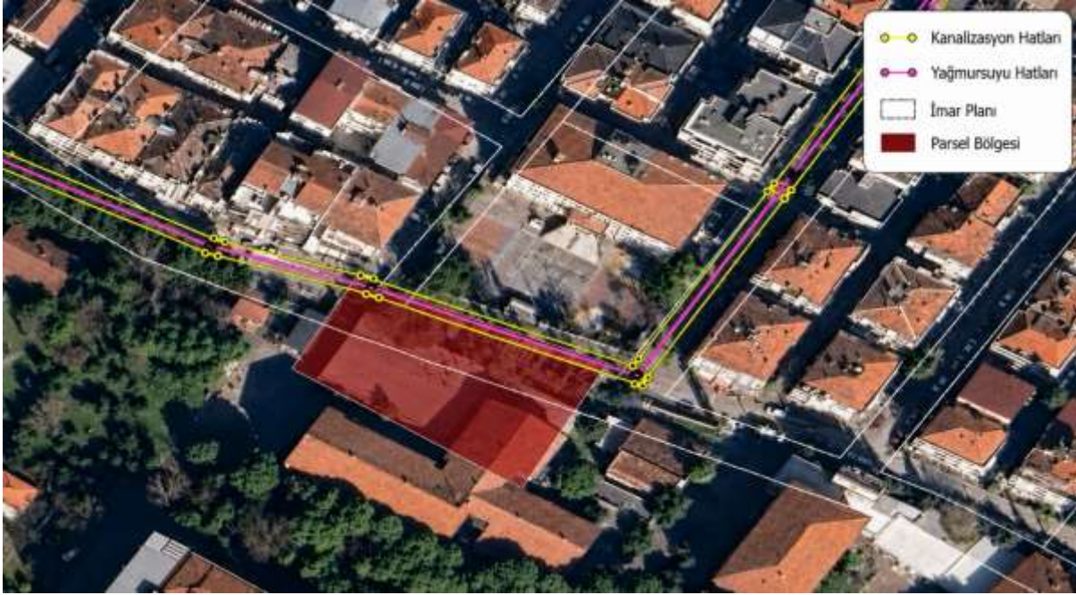
Şekil 3-24 Parsel 574/42 (İnönü Mahallesi)
