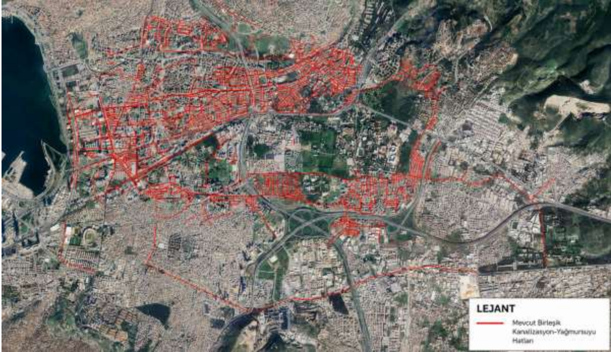
Şekil 3-11 Mevcut Birleşik Kanalizasyon-Yağmursuyu Şebekesi Yerleşim Planı
