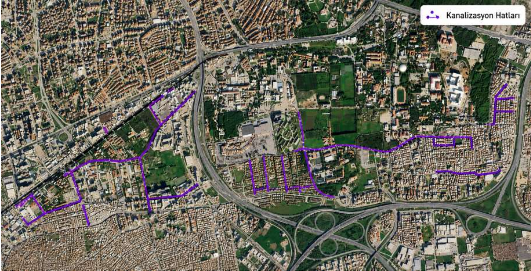
Şekil 3-3 Alt Projenin Kanalizasyon Şebekesi Yerleşim Planı
