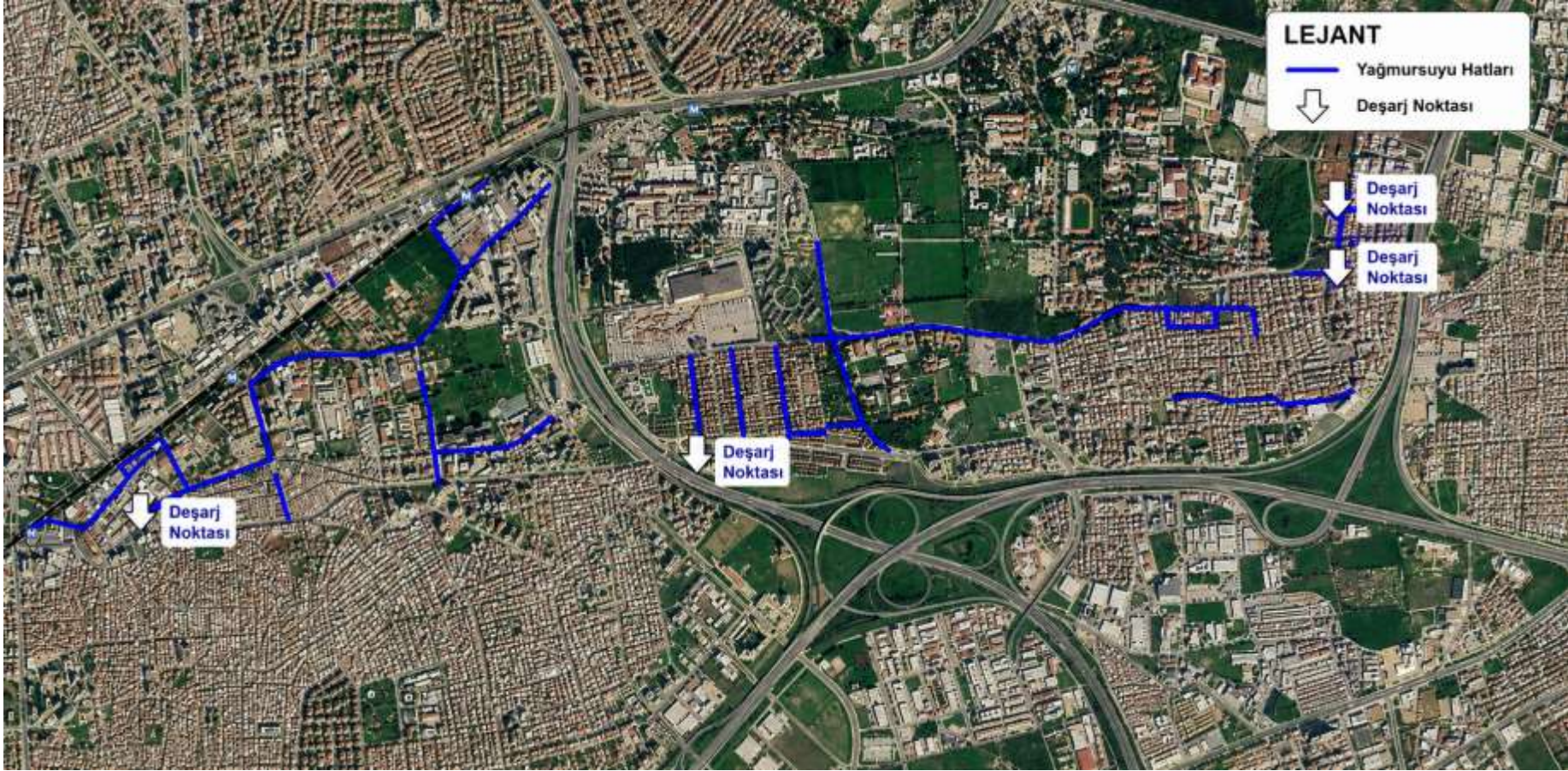
Şekil 3-1 Yağmur Suyu Deşarj Noktaları
